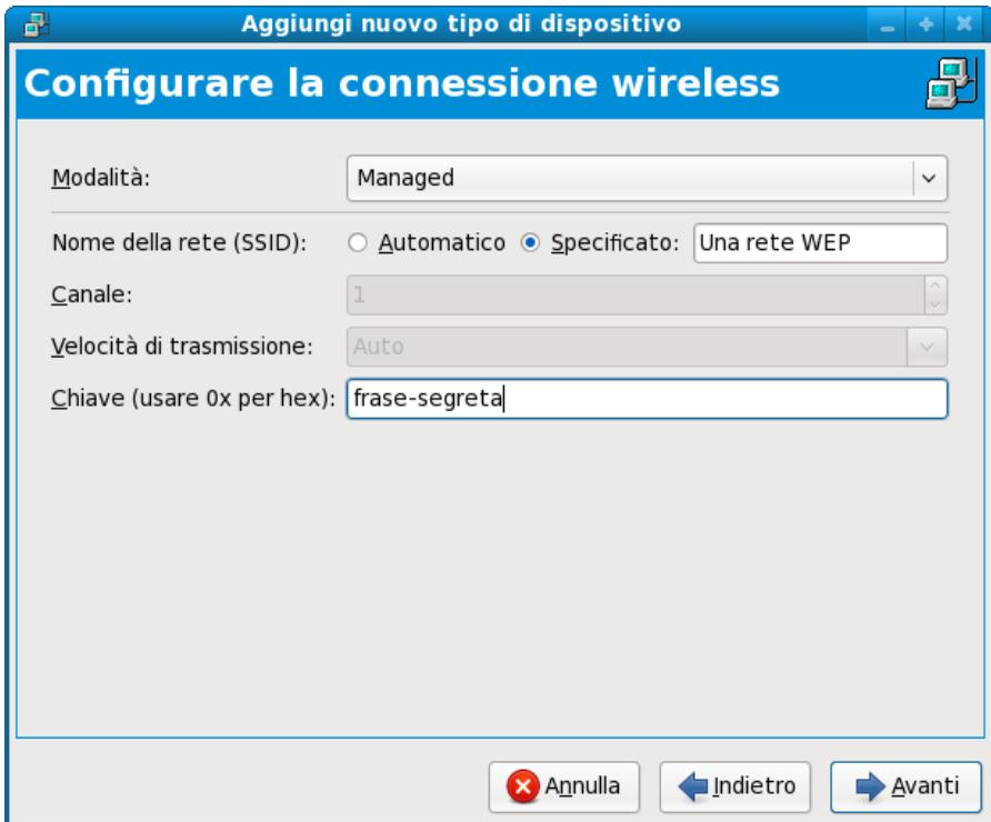
*Figura 3.19* Impostazione della chiave WEP in `system-config-network`
