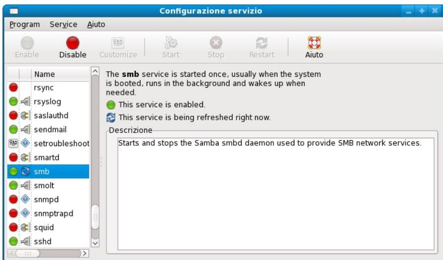
**Figura 3.29** SMB e NMB sono i servizi necessari per Samba
